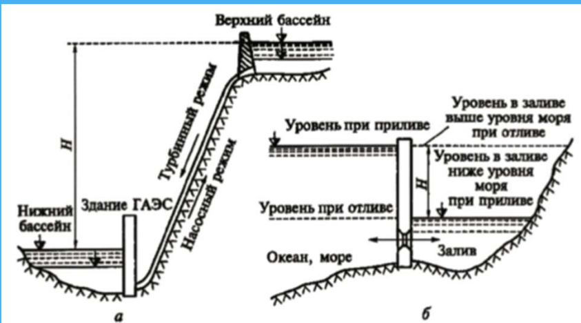
Рис. 2.2. Гидроэнергетический потенциал положения а – ГАЭС, б – приливная ГЭС
